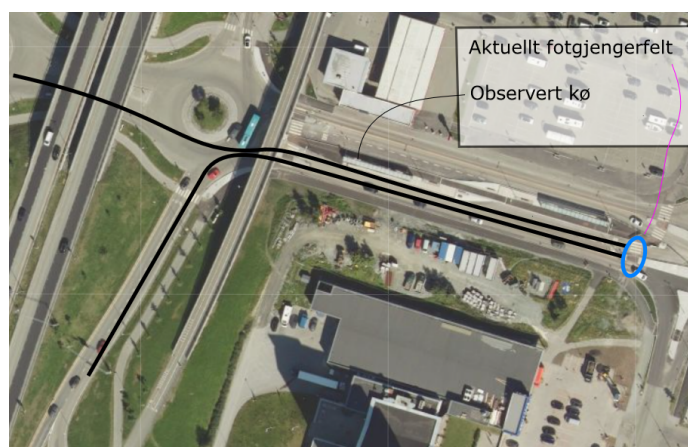
Figur 3.1: Fotgjengerfelt og omtrentlig køutstrekning, befaring 14.11. Bakgrunnsfoto: (Statens kartverk Geovekst og kommunene, 2020)
