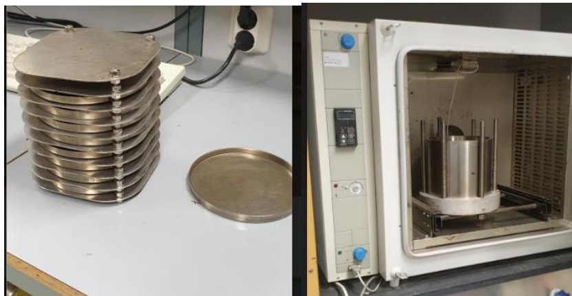
Figur 3. 19: Figur av bitumen beholder og trykkaldningskammer.
