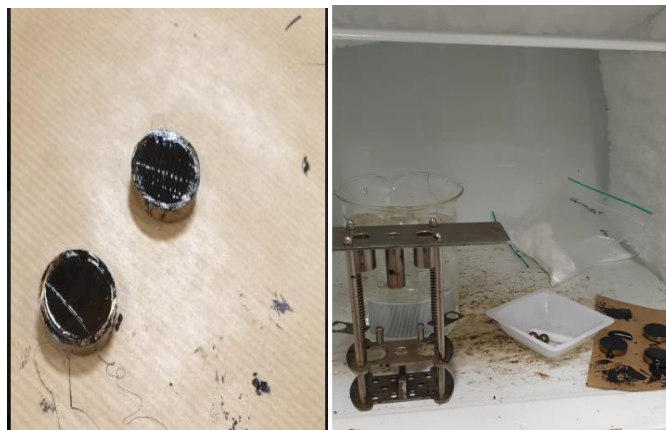
Figur 3. 8: Venstre bilde viser horisontalt bitumen overflate og høyre bilde viser bitumenprøvene, kulene, magneten, mykningspunktapparatet og glassrøret med vann plassert i et kjøleskap.
