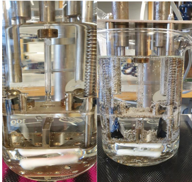
Figur 3. 7: Venstre bilde viser kulene på ringen før testing og høyere bilde viser når kulene treffer bunnen samtidig.
