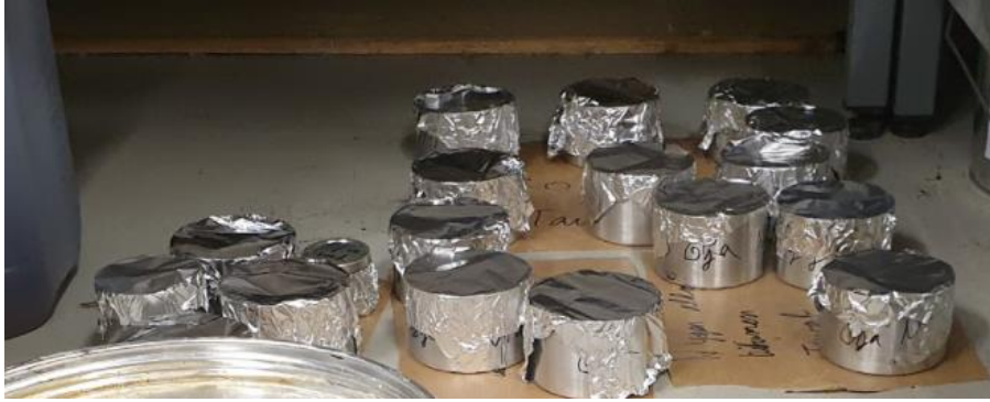
Figur 4. 3: Aldret og ferskt bitumen fordelt i mindre prøvebeholdere.
