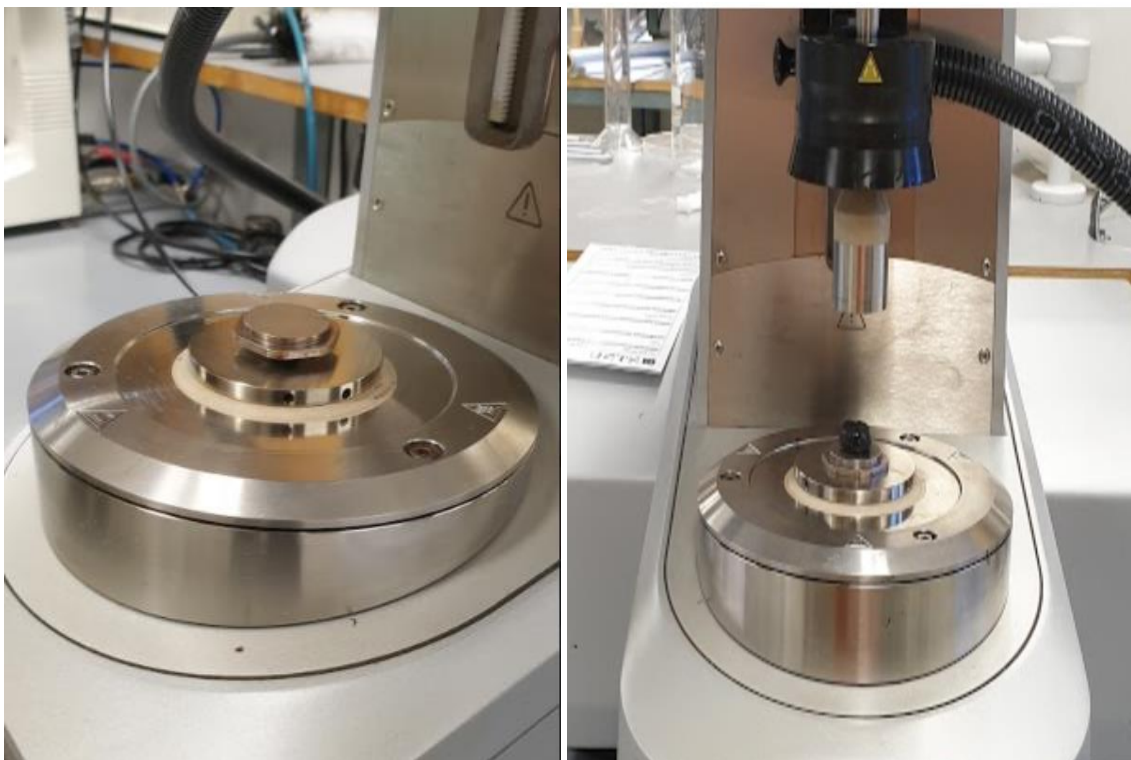
Figur 3. 14: Dynamisk Skjær Reometer apparat med ring og bitumenprøve.
