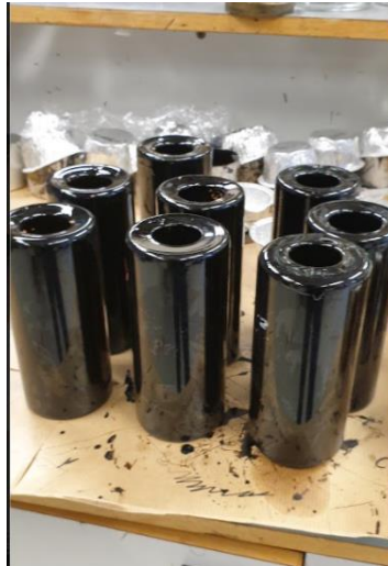
Figur 3. 17: Tap av bitumen i glass etter RTFOT testen.
