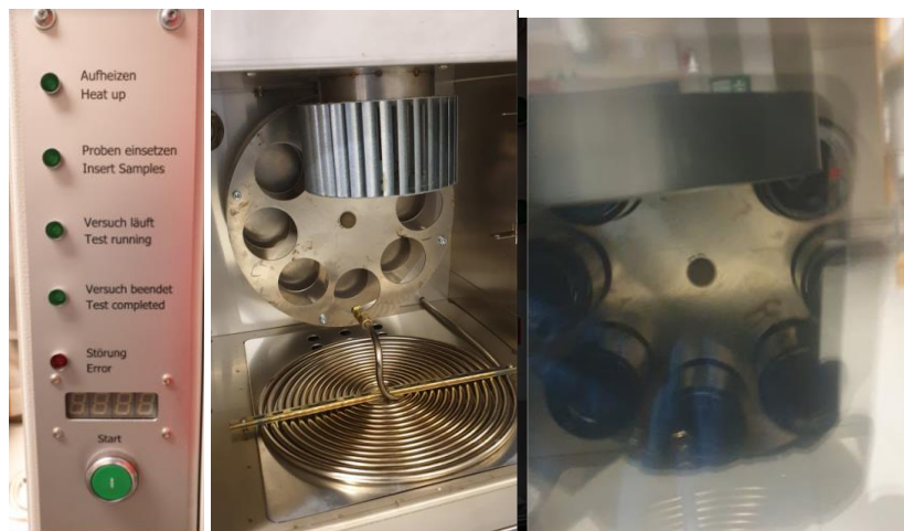
Figur 3. 16: Bilde av fremgangsmåten for Rolling Thin Film Oven apparat, innsiden av apparatet og bitumen i glassene før og etter RTFOT.
