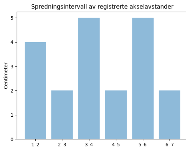
Figur 4.9: Spredningsintervaller av de registrerte akselavstandene fra ATK-punktene
