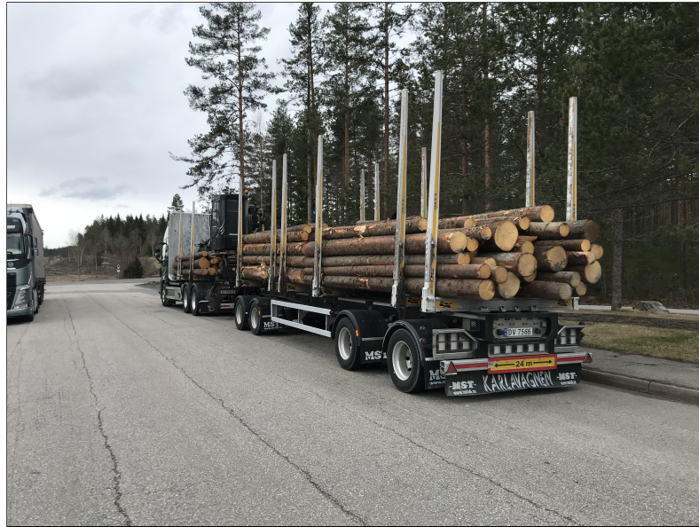
Figur 3.11: Tømmervogntog etter å ha blitt lastet ned til 40 tonn (Foto: Tor Andreas B. Solheim)
