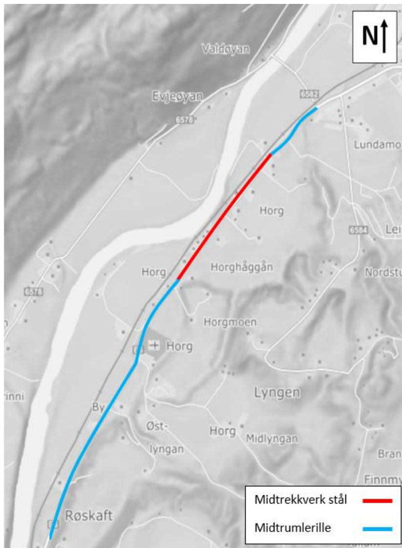
Figur 27 Midtrumleriller i forhold med midtrekkverket (kilde: norgeskart.no)
