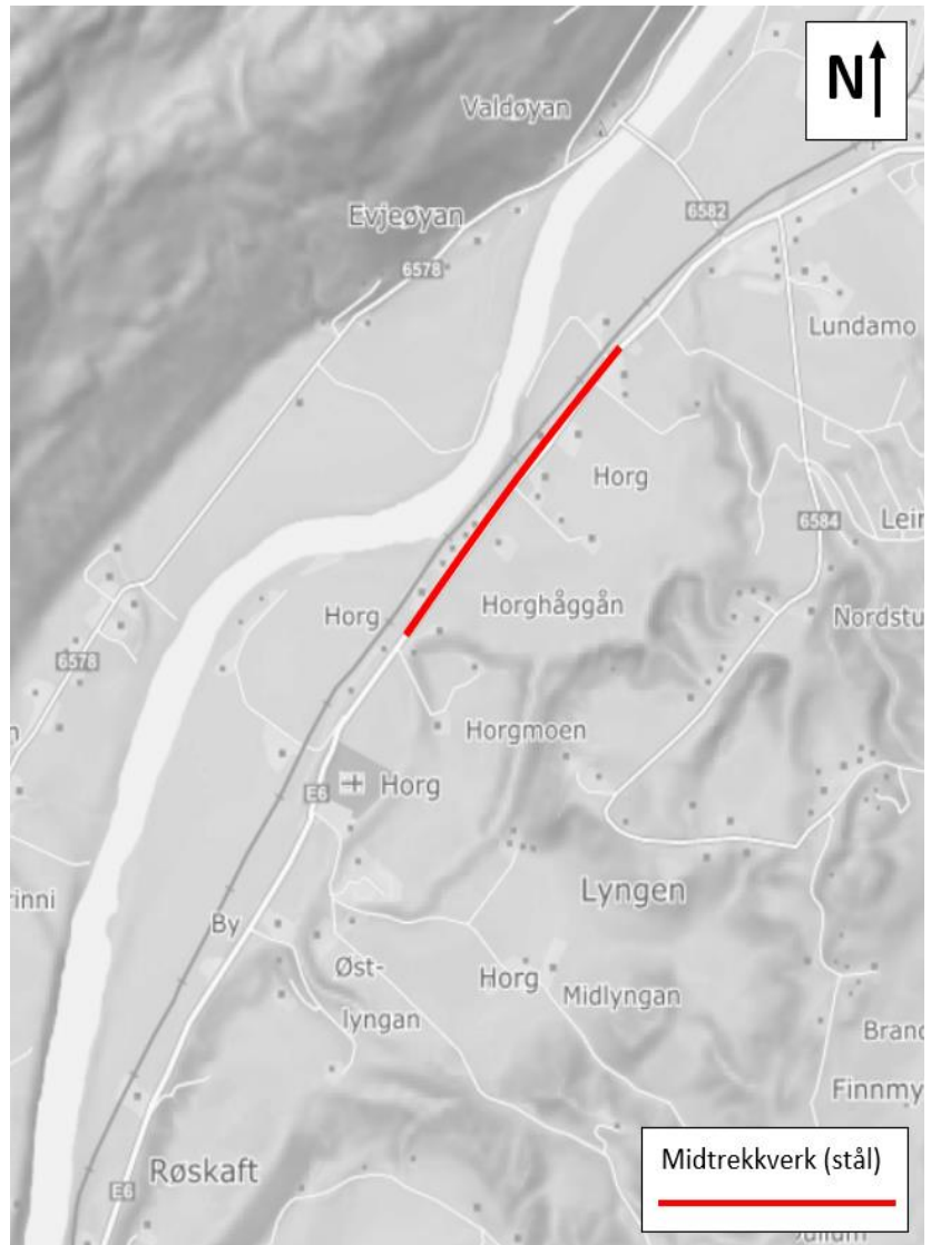
Figur 26 Stål midtrekkverk 900m (kilde: norgeskart.no)
