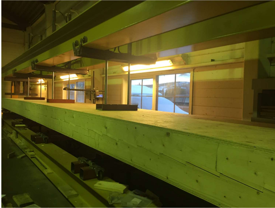
Bilde 27 - Hydraulisk spennbenk, test av Renneubjelkens dimensjonering ved bruddlast. Kilde: Hentet fra vedlegg 3.
