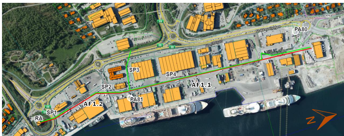
Figur 4: Skisse av eksisterende spillvann og pumpeledning. Rød linje er pumpeavløpsledningen, grønne linjer er spillvannsledninger.
