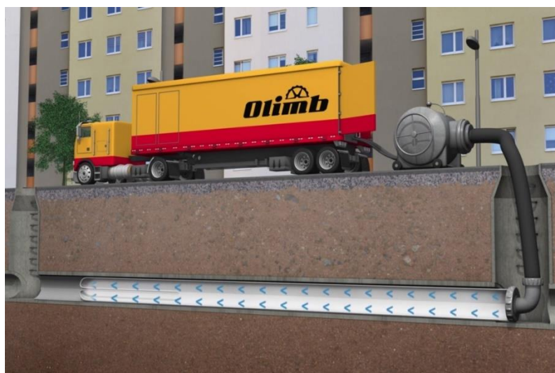
Figur 19: Strømperenovering med lufttrykk (51)
