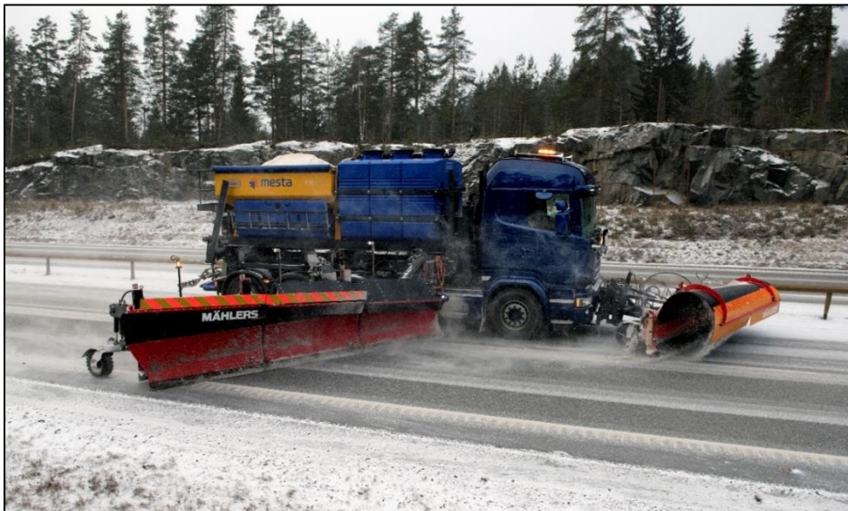
Figur 10: Lastebil fra SLT AS, med sideplog og frontplog. Foto: Mähler International.
