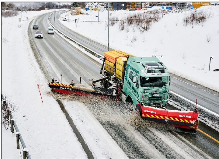
Figur 18: Lastebil som utfører brøyting med front- og sideplog. Foto: Mähler International.
