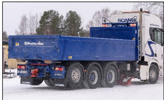
Figur 22 Lastebil med underliggende skjær. Foto: Maehlers international
