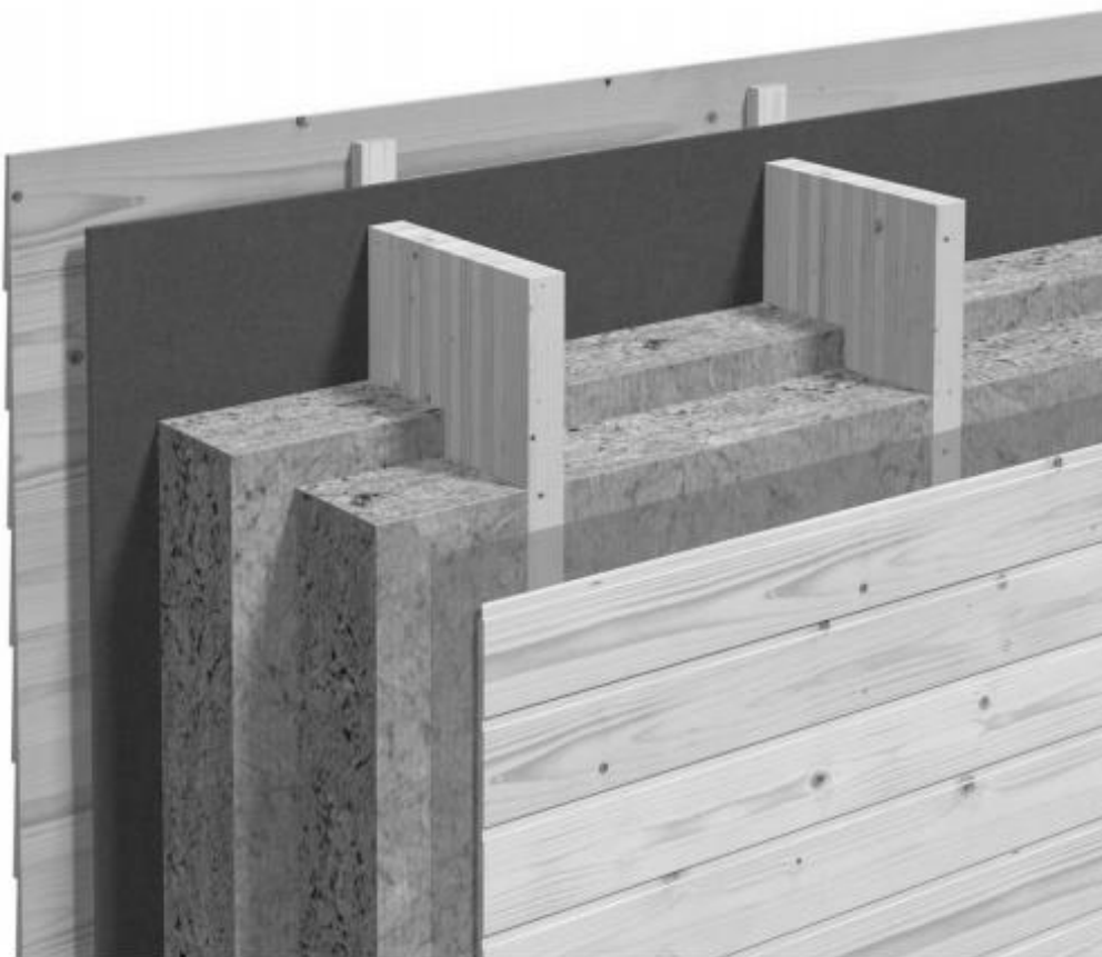
Figur 17 – Visualisering av gjennomgående stenderverk (Norsk Treteknisk Institutt, 2011)
