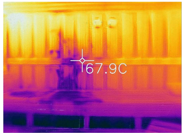
Bilde 17 termisk bilde av øverste benk i badstuen
