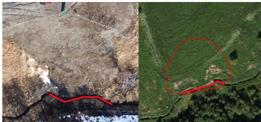
Figur 52 Sammenligning av bekketrase etter og før kvikkleireskred. Dronefoto TV av Maskinentreprenør Roald Madsen AS, flyfoto t.h av Norgebilder.no
