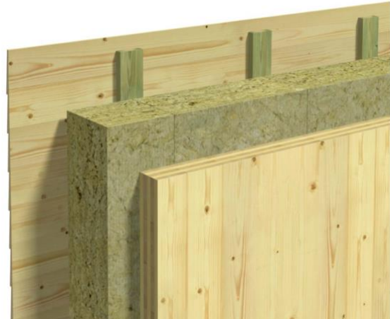
Figur 23: Gjennomgående yttervegg med massivtreelement (38).
