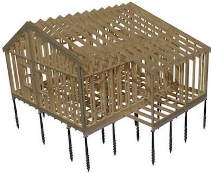
Figur 28: 3D-konstruksjon (rendret i ArchiCAD).
