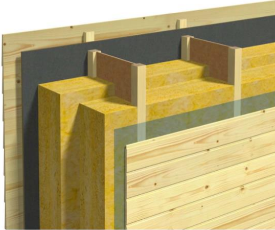
Figur 22: Gjennomgående yttervegg med stendere av I-profil (38).
