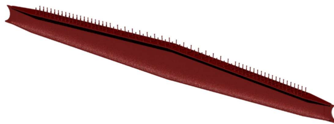
Figur 5-3: Tverrbærer på Forra bru
