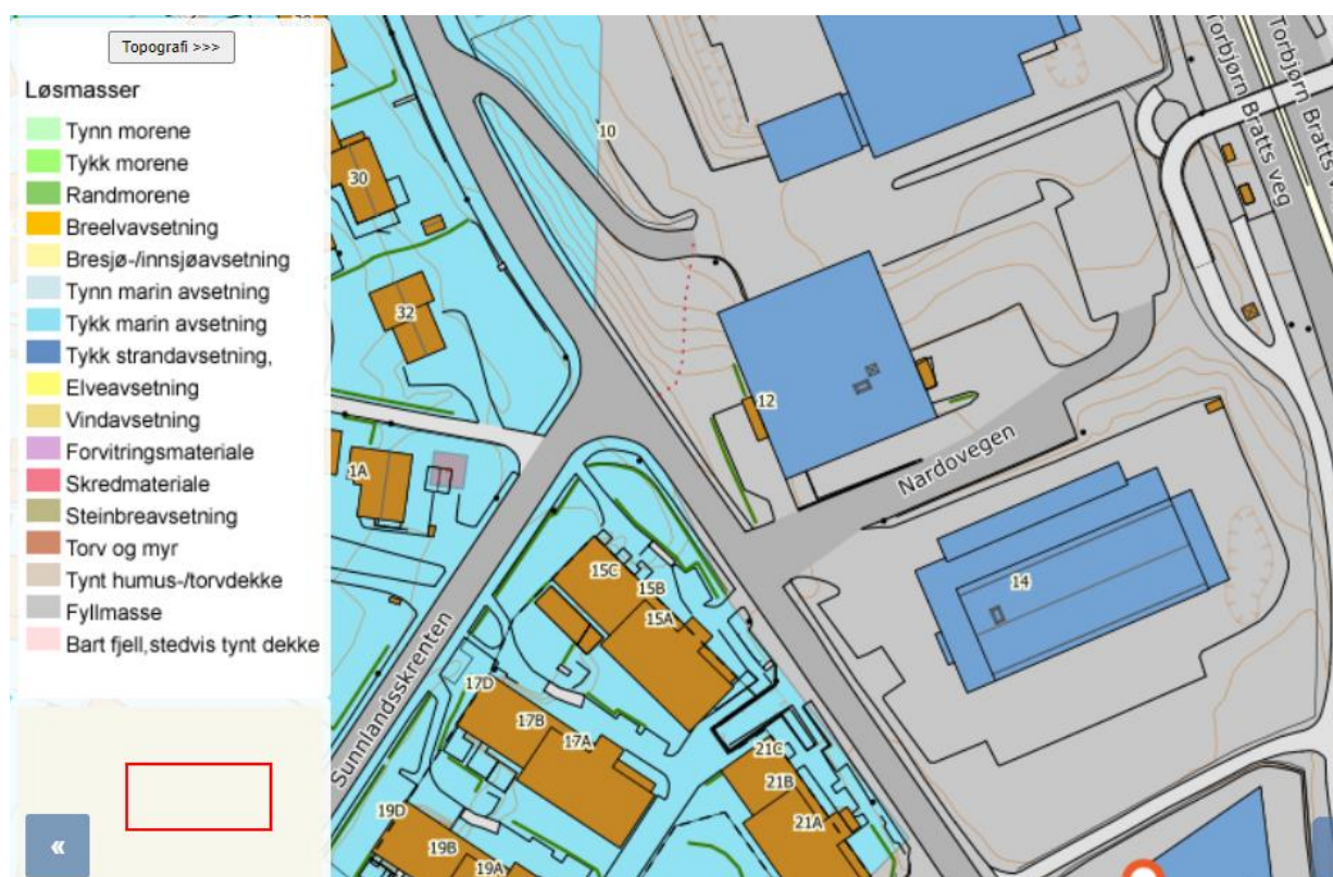
Figur 13 Fyllmasser i grunn
