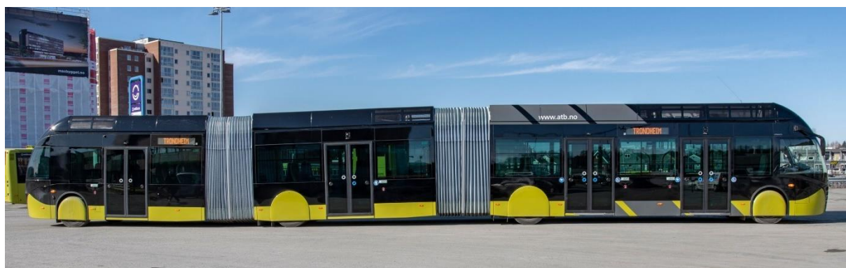
Figur 14 Metrobussrutene betjenes av 24 meter lange buss med tre ledd. Hentet fra: (Trondheim Kommune, 2020)
