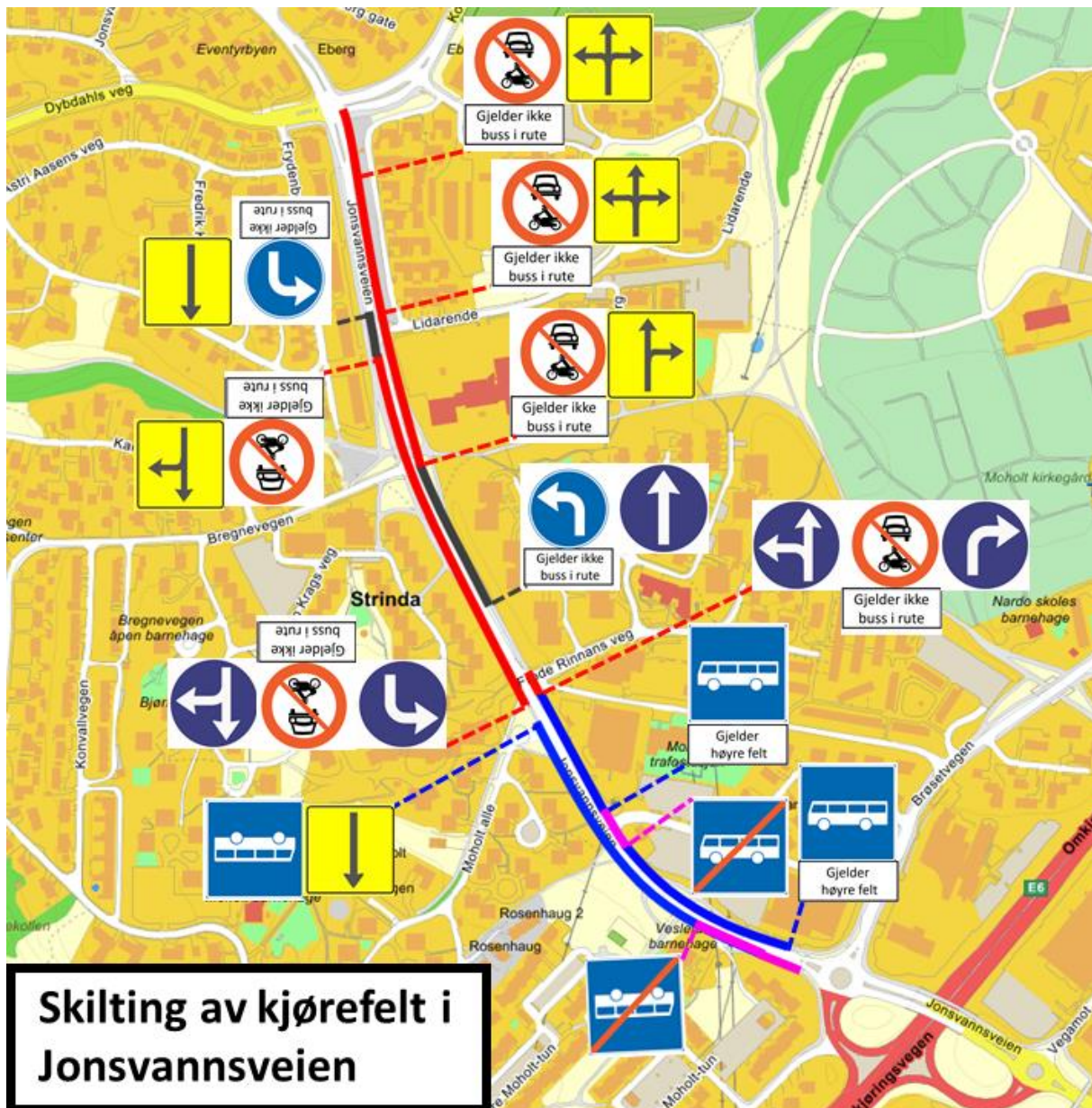
Figur 10 Oversikt over skilting for regulering av kjørefelt i Jonsvannsveien. Bakgrunnskart hentet fra: (Gule Sider, 2020)
