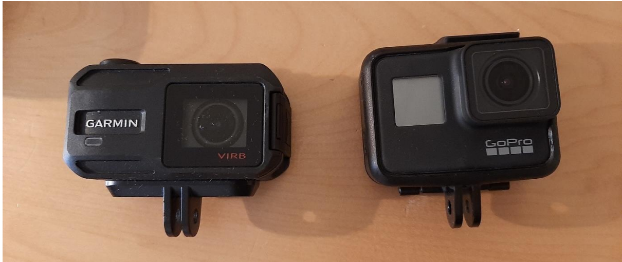
Figur 32 Action-kameraer av typen Garmin Virb XE (t.v.) og GoPro Hero 7 (t.h.) ble brukt til registrering av trafikken.
