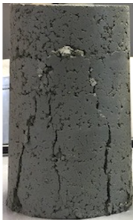
(b) Prøve fra Sivert, 60\text{Kg}/\text{m}^3 med 50/50 Multicem etter enaks skjærttest
