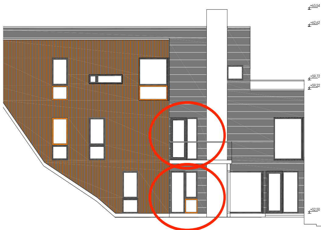
Figur 4.10: Fasadetegning av Bygg B mot vest, med ring rundt to av omtalte fuktskader.
