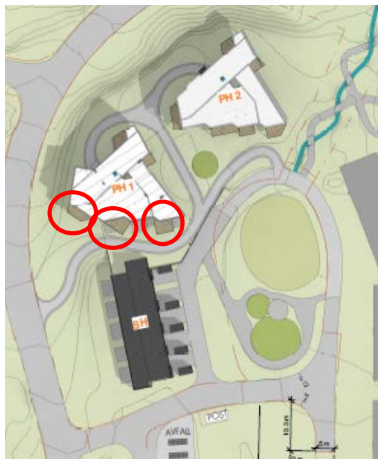
Figur 4.2: Situasjonsplan. Ring rundt altanene med fuktskade.
