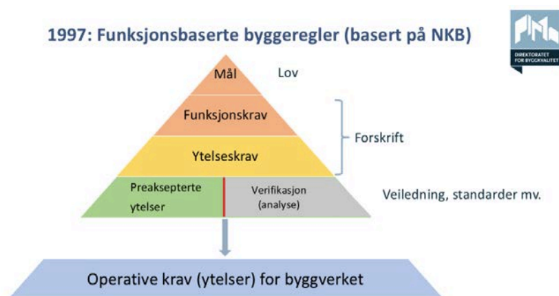
Figur 2.3: oppbygging av funksjonsbaserte byggeregler (Stenstad, 2019).
