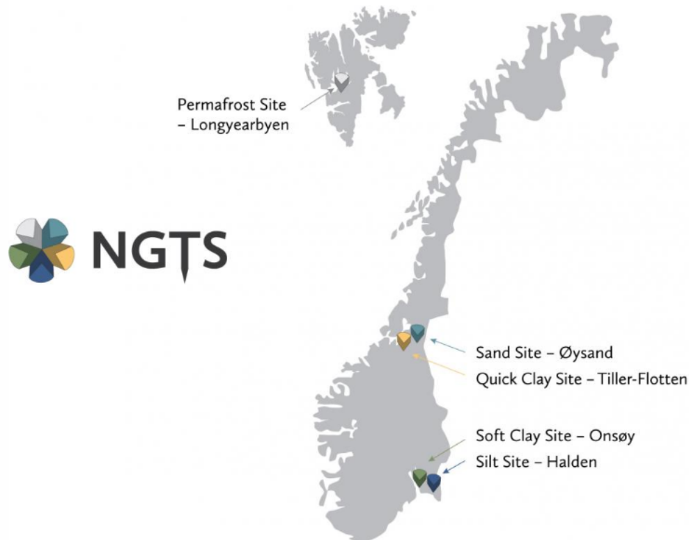
Figur 1.1: Oversikt over NGTS sine 5 prøvetakingsområder i Norge. Prøvetakingsområdene består av et for sand, silt, bløt leire, kvikkleire og permafrost. Den gule markøren viser beliggenheten for Tiller-Flotten området. Figuren er hentet fra NGI [1].
