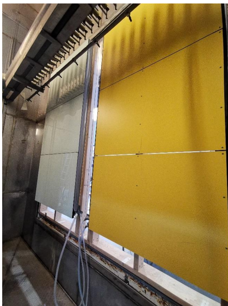
Figur 18 Testrigg festet inn i slagregnsskap med dyserekken senket ned i testposisjon.
