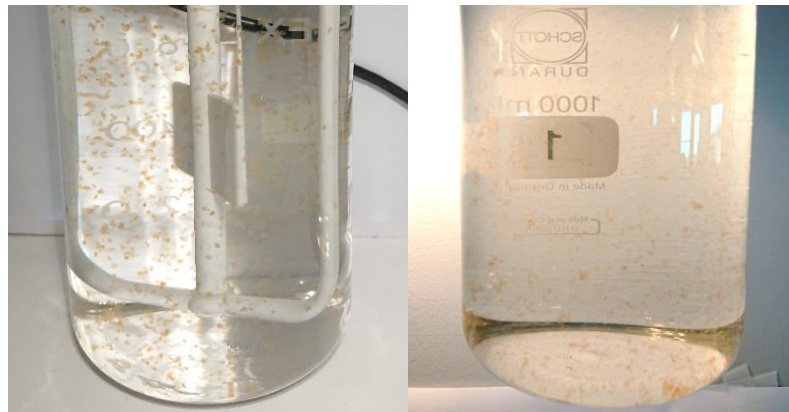
Figur 4-2: Viser forskjell på fnokker fra ALG til venstre og fnokker fra kitosan til høyre.
