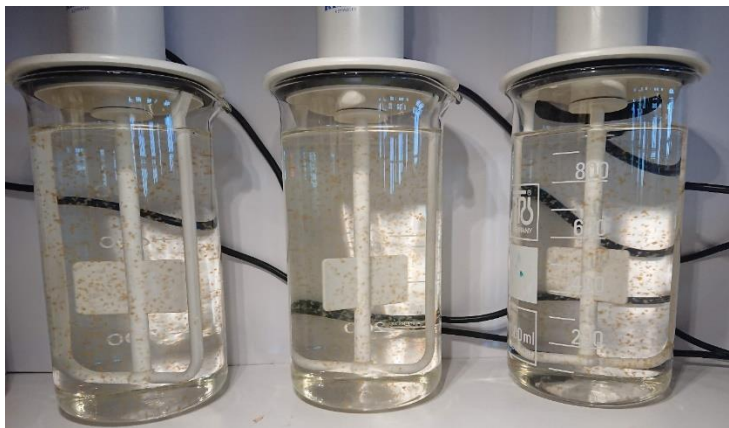
Figur 3-2: Viser oppsett for jar-testene utført i denne oppgaven.
