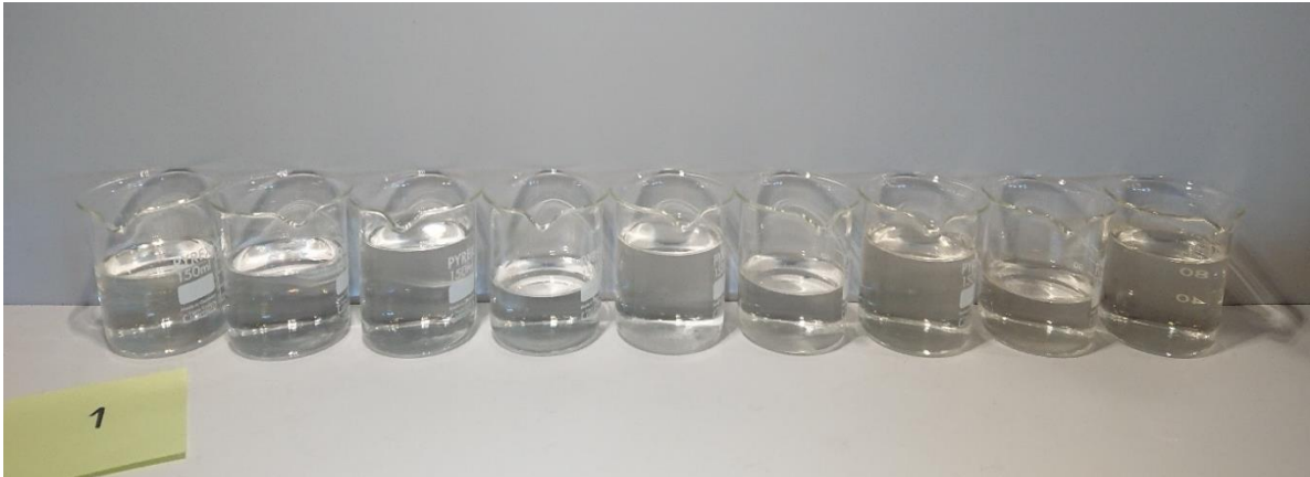
Figur 4-4: Eksempel på resultater fra en filtersyklus. Hvert glass representerer en prøve som er tatt hver time inn i filtersyklusen. På bildet kan man tydelig se hvor filteret har gått til brudd hvor vannet skifter farge fra klart til brunaktig. Bildet er tatt selv.
