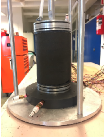
(d) Installing top head, porous stone and filter paper
