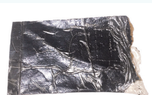
Eldre dampsperre, trolig fra 1962. Diffusjonstett bygningspapp med foliebelagt fremside.
