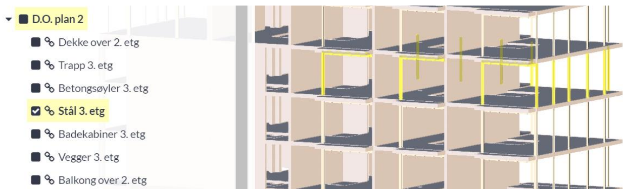
Figur 25: Gruppering av stål i 3. etasje
