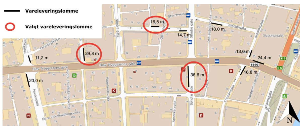
Figur 15: Oppmålte lengder på vareleveringslommer i tilknytning til Olav Tryggvasons gate. (FINN, 2020).
