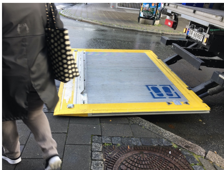
Figur 66: Illustrasjon av bakløfter nedsenket på fortauskant. Foto: Jørgen Rødseth.
