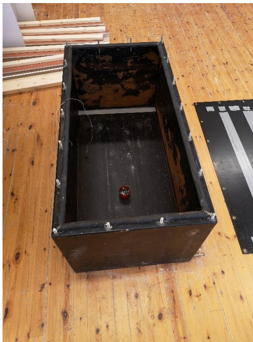
Figur 21: Test- og oppfuktingsboksen som benyttes i forsøket
