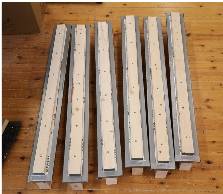
Figur 27: Prøvestykker med beskyttende teip langs kanten
