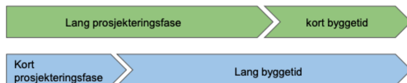
Figur 4: Prosjektering- og gjennomføringsfase i et massivtreprosjekt kontra et tradisjonelt bygg (Nordisk Massivtre, u.å)
