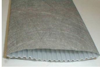
Figur 3.5: Prefabrikkert dren. Bilde hentet fra Geoengineer.org (Geoengineer.org, 2020).
