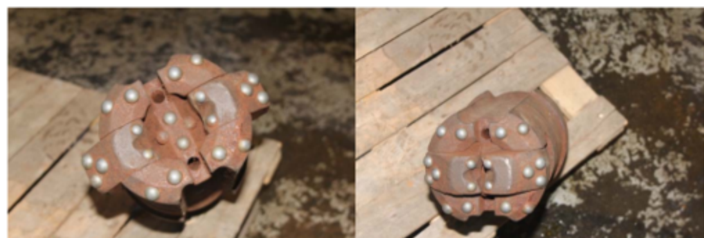
Figur 6: Vingeborkrone med vinger inn- og utfelt ved hjelp av matekraft. Hentet fra (Veslegard & Simonsen, 2014).
