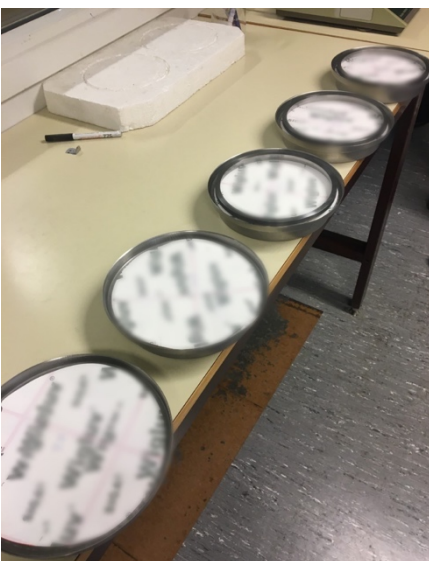
Figur 5: Prosedyre for måling av vanndampgjennomgang av bygningstape.
