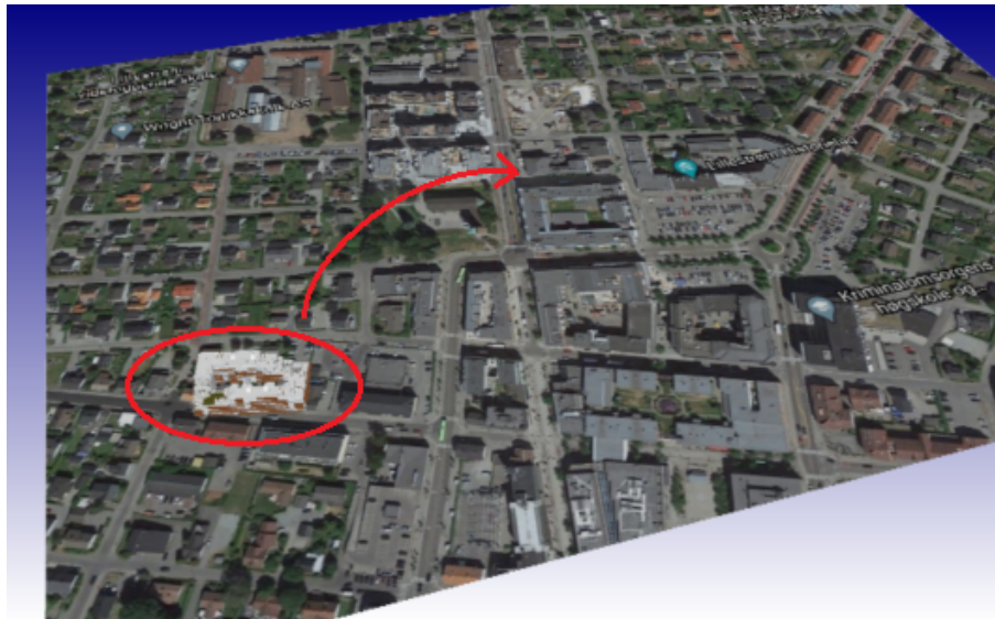
Figur 11: Kart ligger feil plassert i forhold til bygget.
