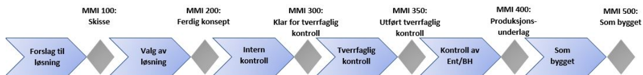
Figur 8: Forslag til MMI-prosess med tilhørende MMI-nivåer, basert på Fløisbonn et al. (2018, s. 4)
