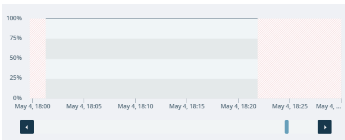
Figur 53: Signalstyrke gjennom sikringsskap for sensor med range extender
