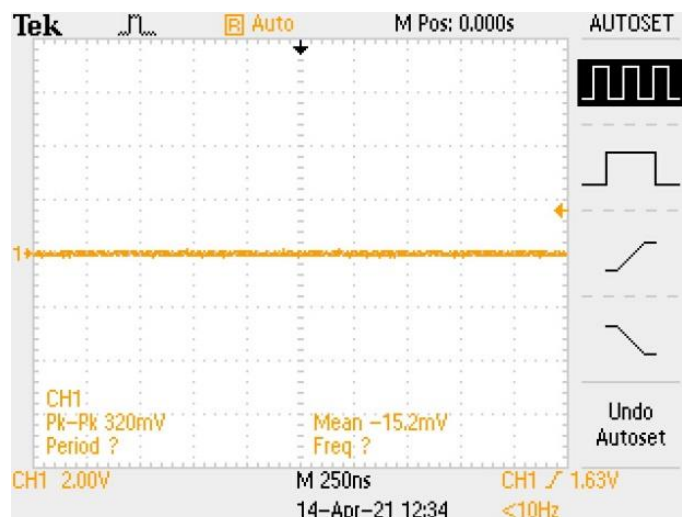
Figur 5.10 Utgang signal når reset og start knappen er ned trykket. For å teste nullstillingsfunksjonen til programvaren Key0 = 0 og Key1 = 0
