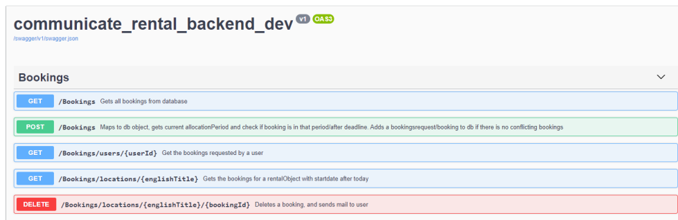
Figur 7.1: "Swagger UI" - brukergrensesnitt for bruk og dokumentasjon av API-endepunkter
