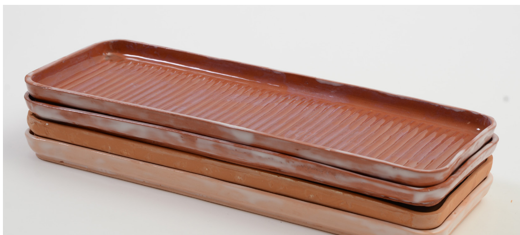
Glasuren på de endelige prototypene ble for tykt og ujevnt påført. Rillene mangler på den avbildete oblongen
