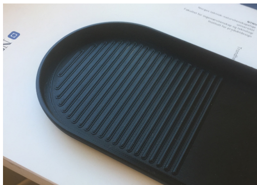
Test av avstand fra kant til rillene starter
