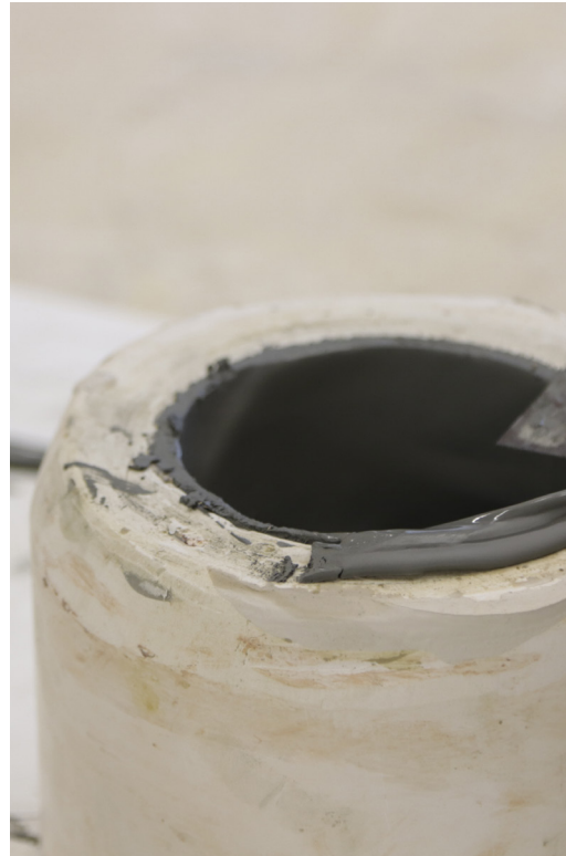
Den størknede kanten fjernes
