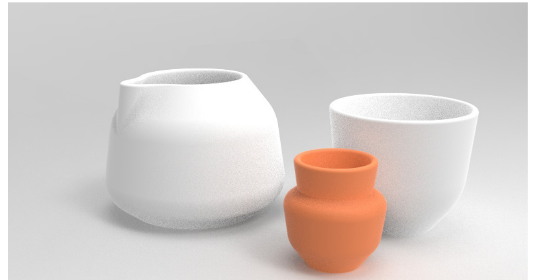
3D-printede mockups av melkemuggen brukt til helletester
