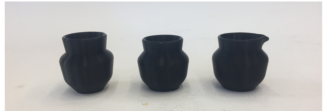
3D-printede mockups av melkemuggen brukt til helletester
