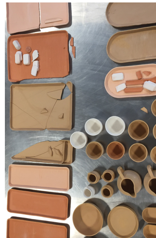
Noen av de tingene som gikk galt under prosessen; feilstøp, uforsiktig håndtering, ujevn glasur
