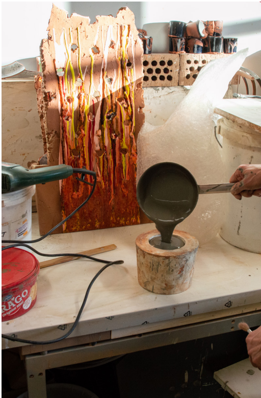
Støpemassen helles i gipsformen
