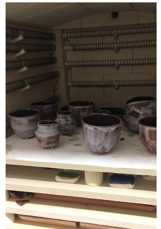
Noen av de tingene som gikk galt under prosessen; feilstøp, uforsiktig håndtering, ujevn glasur
