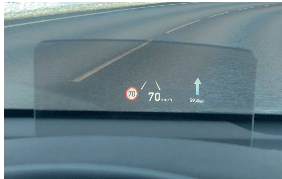
Head-up display: HUD blir stadig vanligere å finne i nye biler. Displayet er lokalisert foran rattet.
