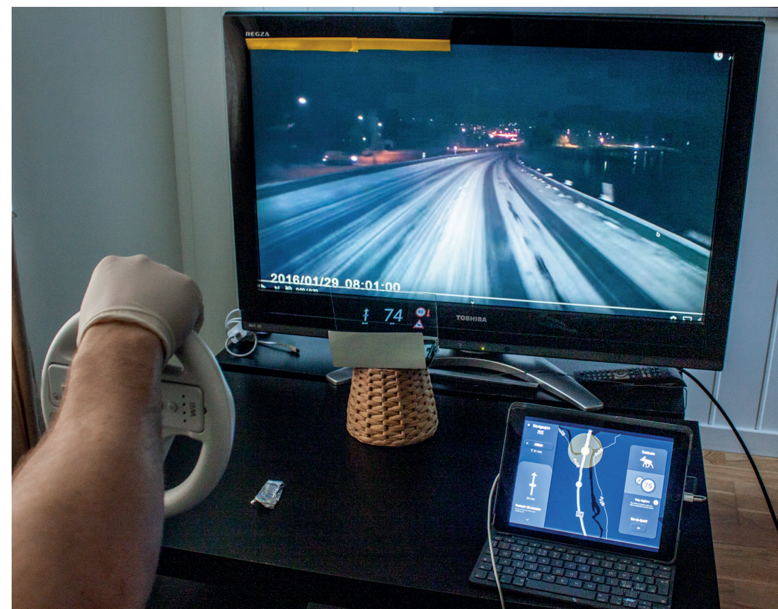
Wizard of Oz: Oppsett av brukertest, med iPad som dashboard, TV som frontrute og mobil med pleksiglass som head-up display.
