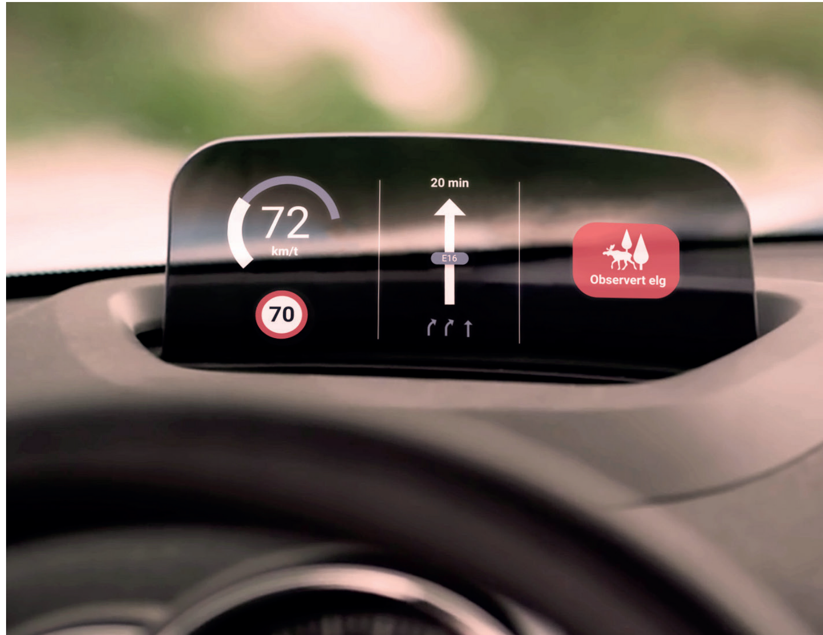
Head-up display: Aktivt varsel om observert elg. Originalt bilde hentet fra Bavaria Norge (2017).
