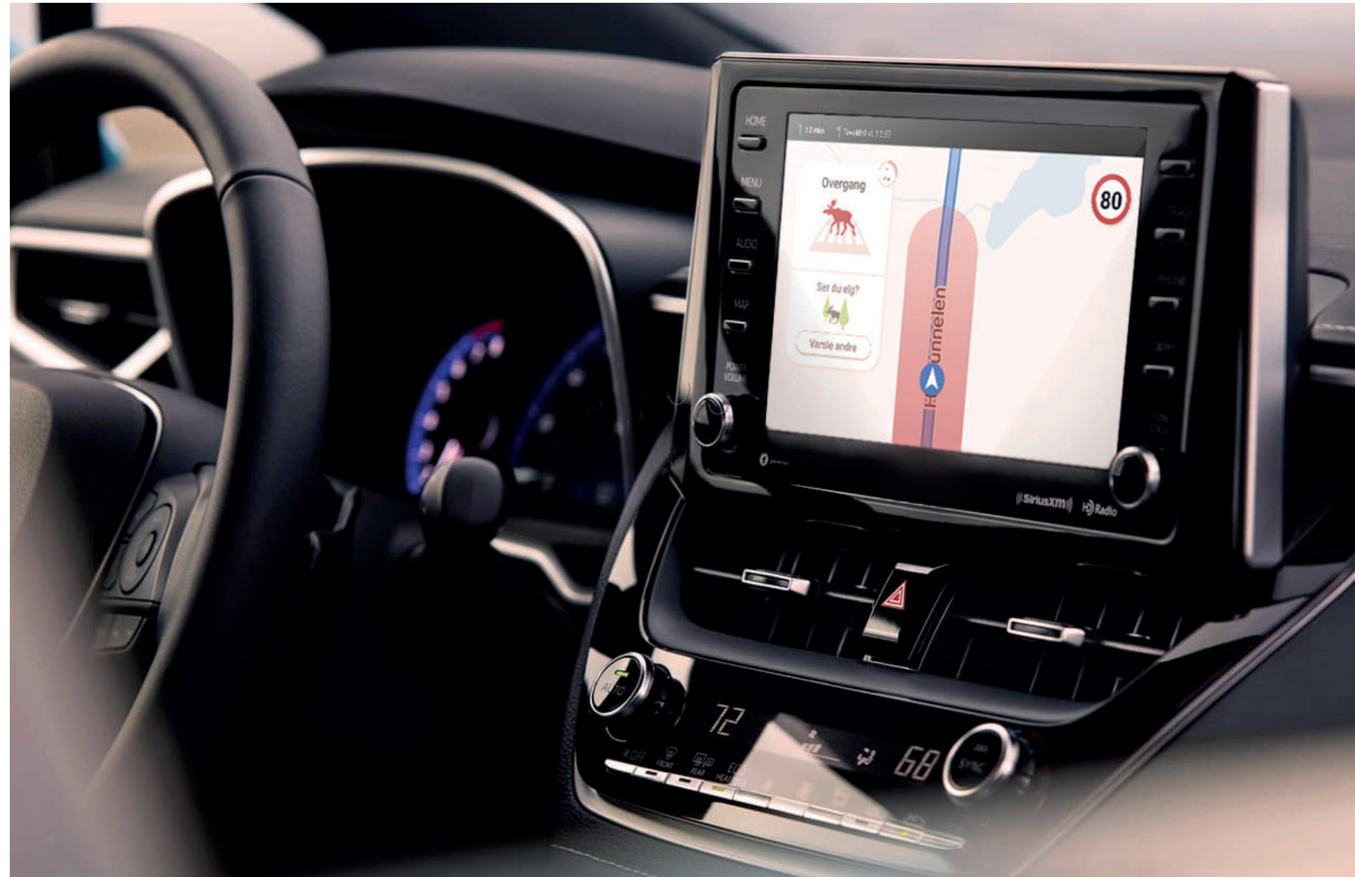
Overgang: Viltvarsleren varsler om økt kollisjonsrisiko ved overgang. Originalt bilde hentet fra Toyota (2020).
