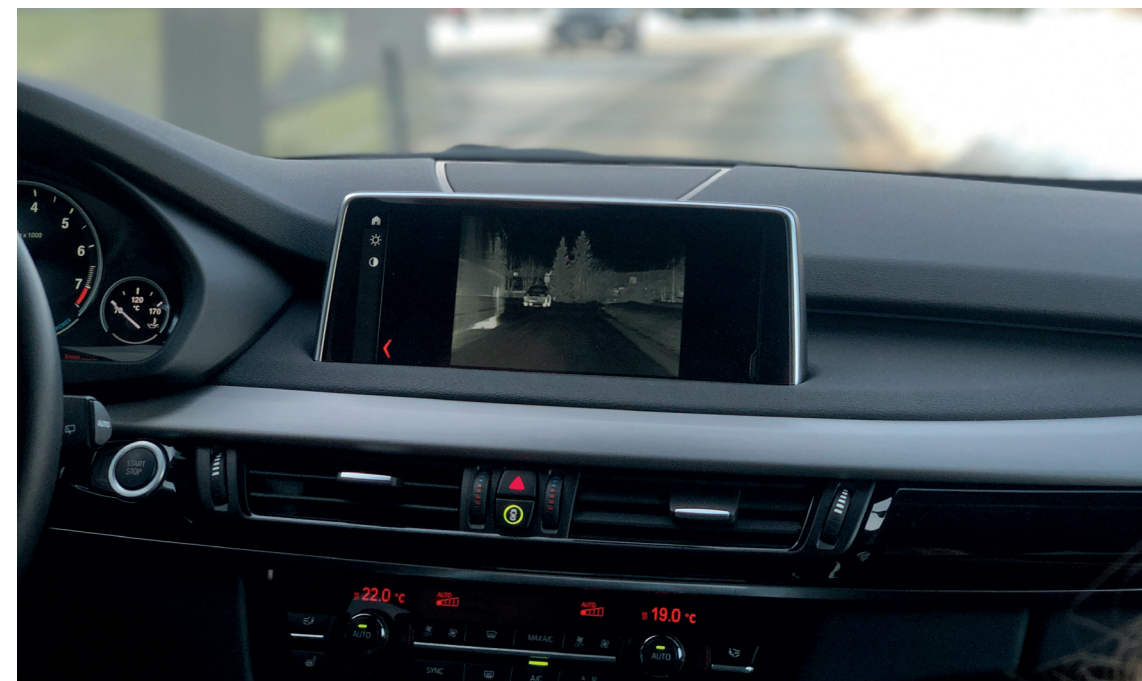
IR-kamera i bruk: Her ser man at hjulene på bil i motgående kjørefelt er varme, og dermed markert hvite.
