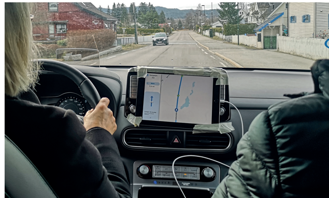
Bilde fra brukertest: Sjåfør og passasjer kjører på veien og får varsel om elgfare. Ipad brukes som dashboard.
