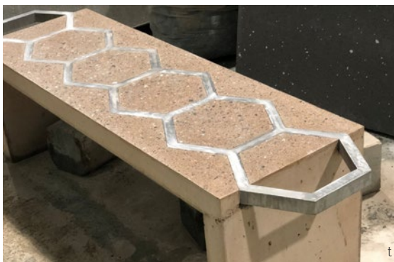
Betongbenk med synlig aluminiumsarmering.
