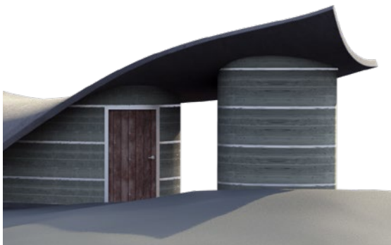
Visualisering av synlig aluminium og betong støpt med liggende bordforskaling. Dørrammen kan støpes rett inn i veggene.
