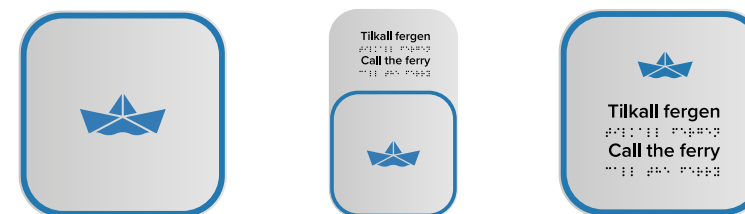
Figur 15: Utvikling av tilkallingsknappen. Endelig utforming lengst til høyre.
