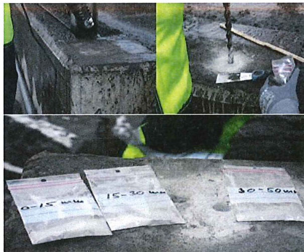
Figur 12 Gjennomføringen på boreprøver av Sandvold bru (fotograf Sangar Sangasari)
