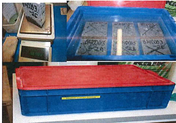
Figur 22 veiing av prøvestykkene og i \text{Ca}(\text{OH}_2) -løsningen (kalsiumhydroksid) (fotograf Sangar Sangasari)
