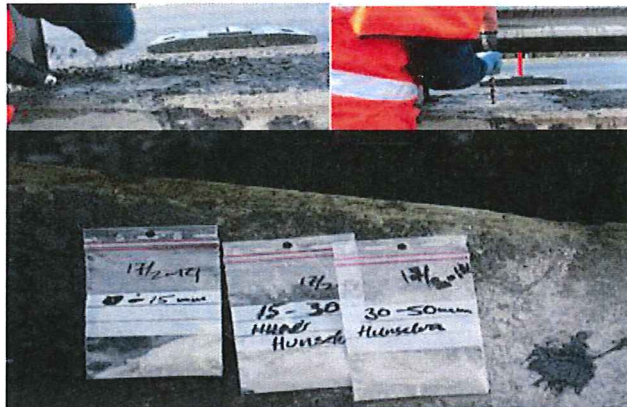
Figur 11 Gjennomføringen på boreprøver av Hunnselva II bru (fotograf Sangar Sangasari)
