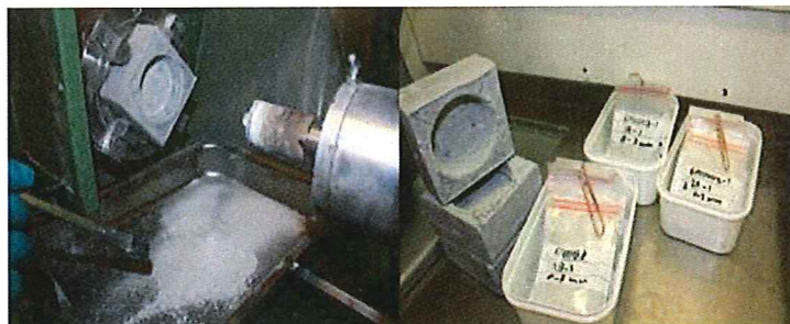
Figur 25 Fresing av 3 prøvestykker i 8 sjikt (fotograf Sangar Sangasari)
