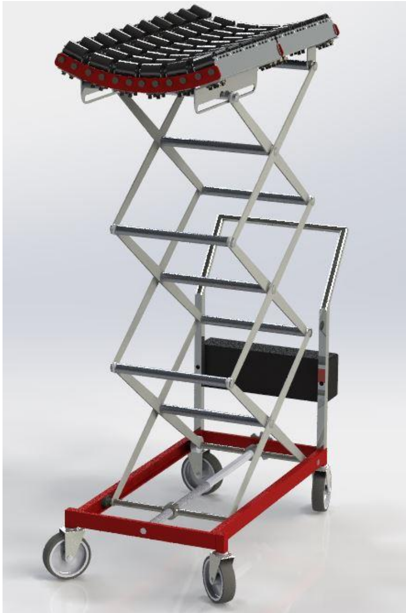
Figur 24: Ferdig sammenstilt løfteanretning oppheist
