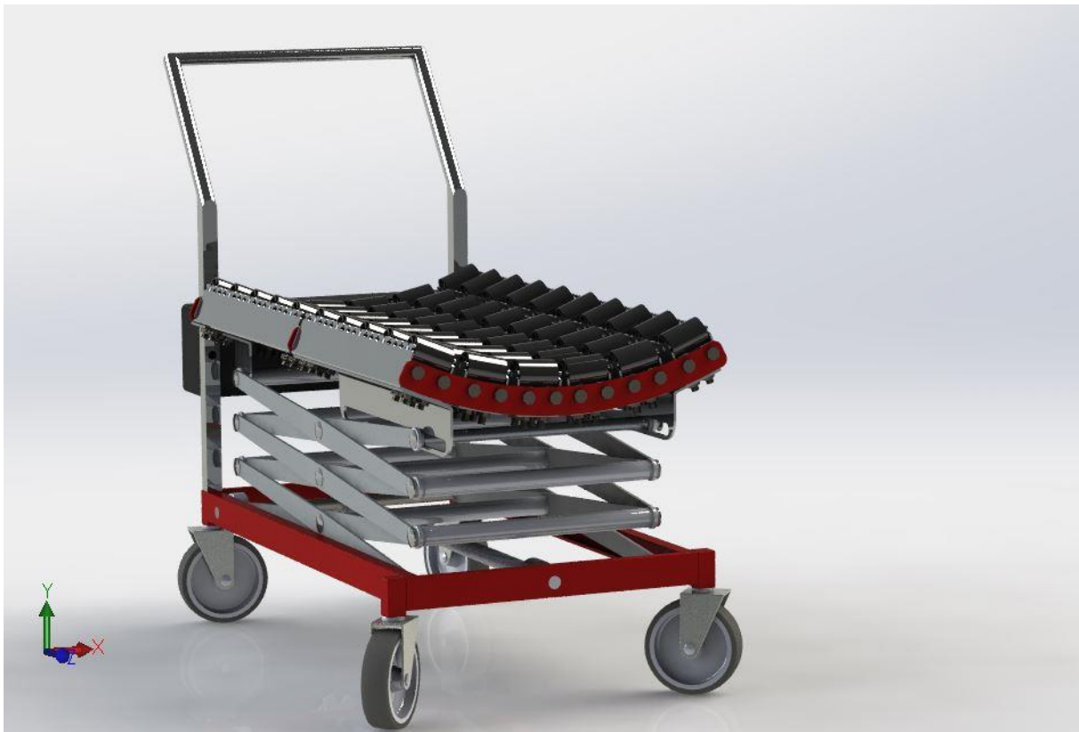
Figur 23: Ferdig sammenstilt løfteanretning for stoffruller
