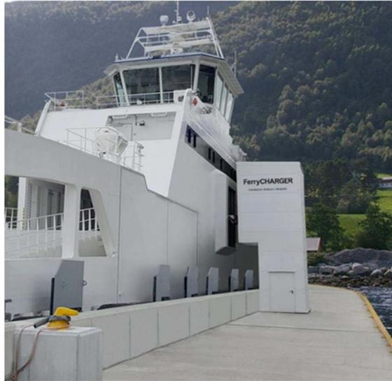
Figure 11: Stemmann-Technik FerryCHARGER. Photo: Stemmann-Tecnik
