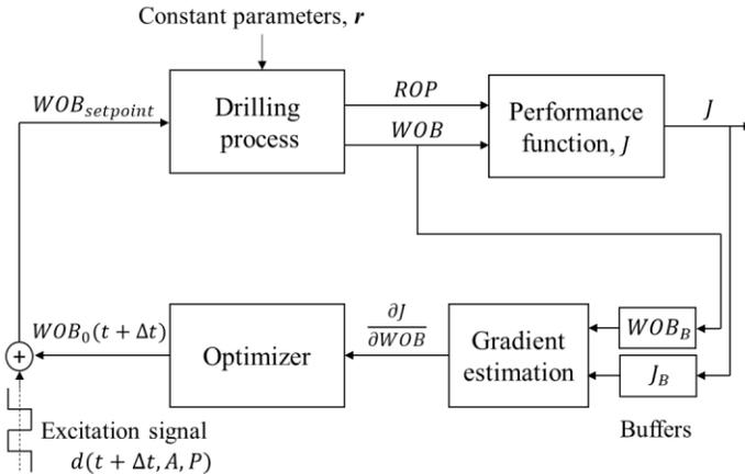
**FIGURE 3:** ES SCHEME FOR UNCONSTRAINED DRILLING OPTIMIZATION.
