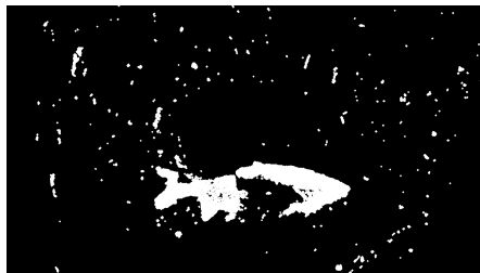
Figur 4.7: Skjerm bilde av hvordan funksjonen for morfologisk transformasjon fungerer i et bilde fra videomaterialet med tilpassede parametere.
