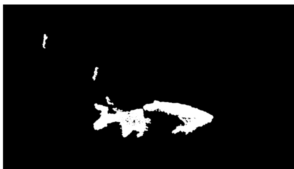
Figur 4.9: Skjermbilde av hvordan funksjonen for tilkoblede komponenter fungerer i et bilde fra videomaterialet med tilpassede parametere.
