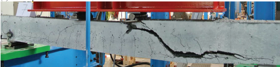
(d) Shear span ratio 3.43 - beam 5
