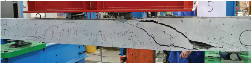
(d) Shear span ratio 4.0 - beam 4
