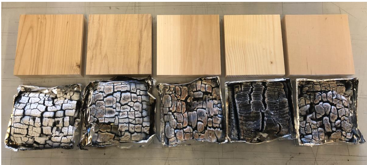
Figur 21: Prøvestykker før og etter testing i konkallorimeter (fra venstre: hegg, lønn, rogn, ubehandlet gran og bjørk)
