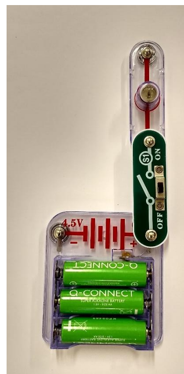
Figur 16: En brutt krets hvor lyspæremodulen kun er koblet til en av batteriets poler.
