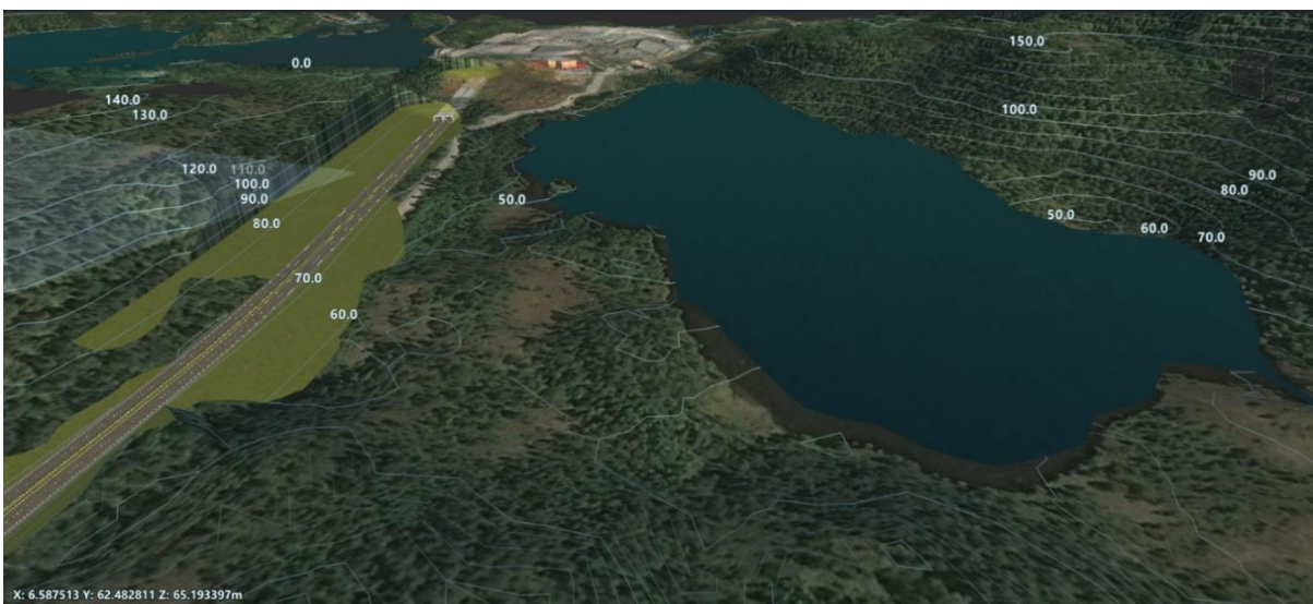
Figur 63: mulige sikringstiltak i enkelte strekninger kan være å øke avstand fra veg til vannkilden
