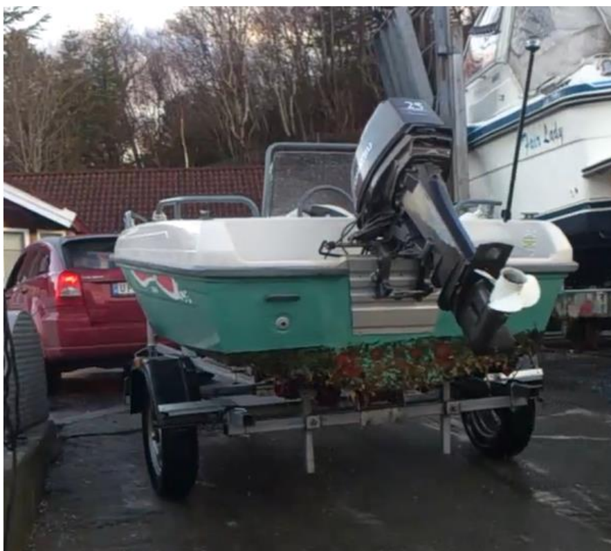
Figur 14 Illustrerer begrodd skutebunn. Dette skaper stor friksjon. Foto: Sindre Furuli
