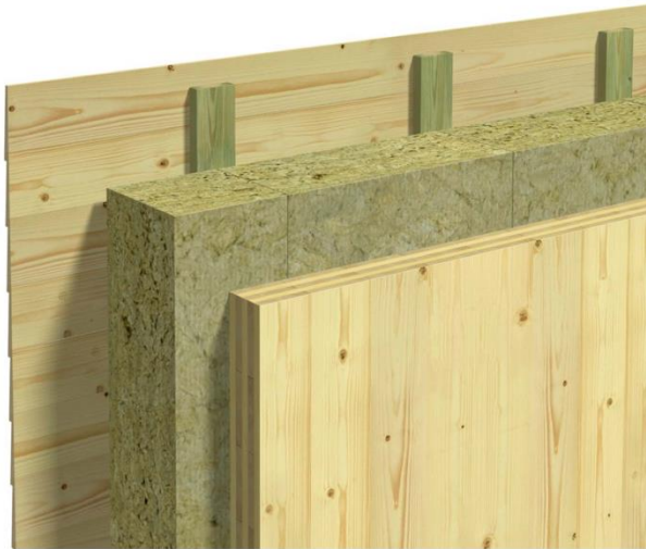
Figur 9. Yttervegg oppbygd med massivtreelement. (41)
