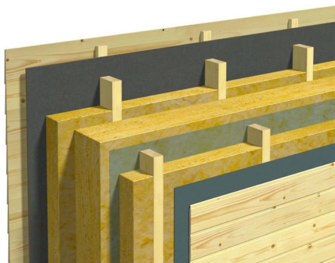
Figur 10. Yttervegg med todelt stenderverk og gjennomgående isolasjon. (41)
