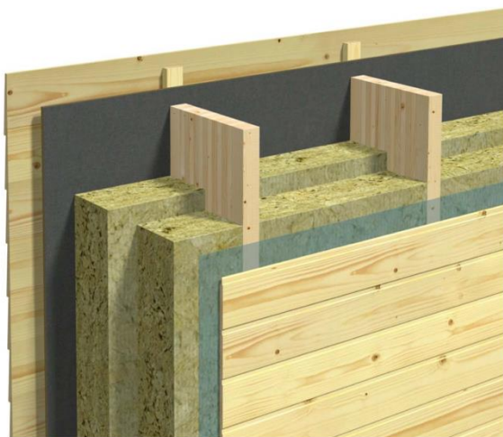
Figur 8. Gjennomgående yttervegg av sammenlimte lameller. (41)
