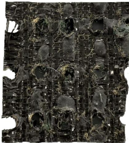
Figur 22: Oversiden av backingen fra ScanTurf sydd sammen fra bånd av PP der gressfiber festes fast i åpningene.
