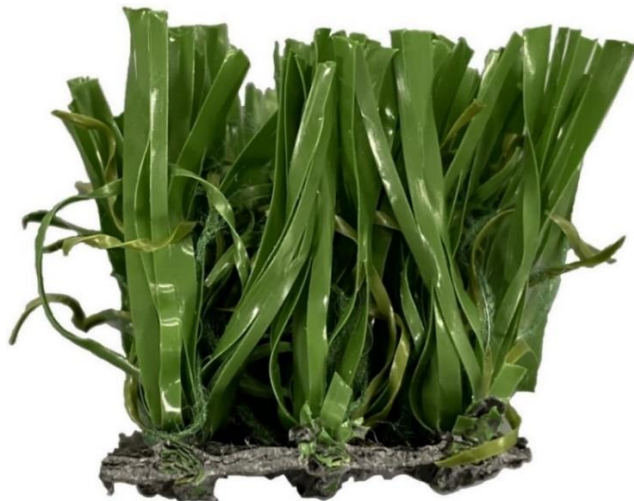
Figur 21: Tverrsnittsbilde av 4G-kunstgress med kunstgressfiber sydd fast i backing.
