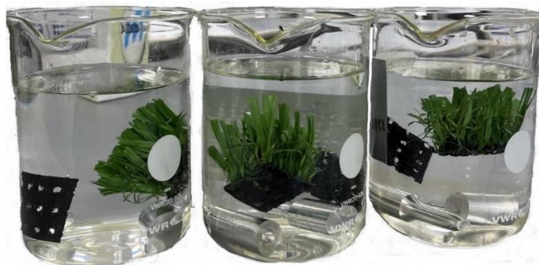
Figur 31: Prøvestykker av fiber og backing senket i løsning med 10 vekt% NaCl.
