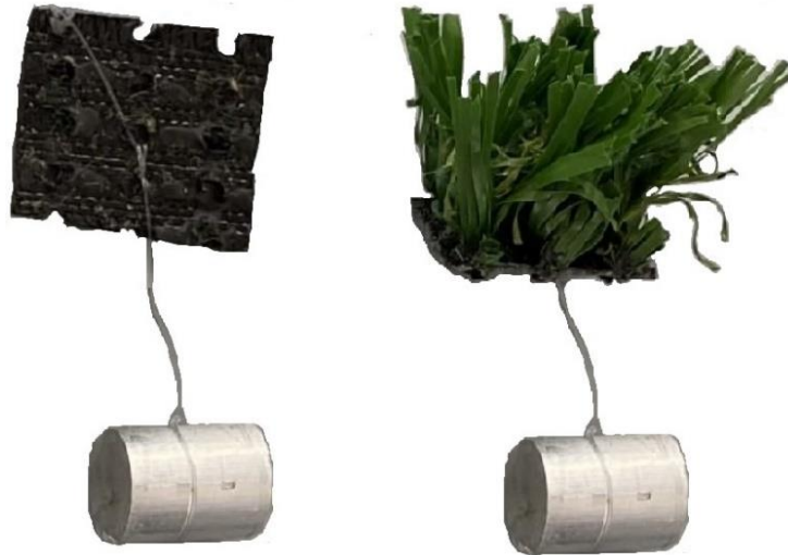
Figur 30: Prøvestykker av backing og fiber festet med fiskesnøre til aluminiumsklosser før salteksponering. Klossene ble brukt for å sørge for at prøvestykkene forble omringet av væske.
