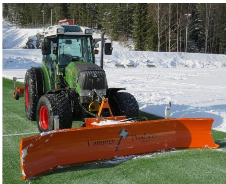
Figur 26 Eksempel på mekanisk fjerning av snø og is ved anbefalt traktor med et Hammer SP-355 skjær [52]. Skjæret har en gummiforing i bunnen for å unngå metallkontakt mot fiberen.
