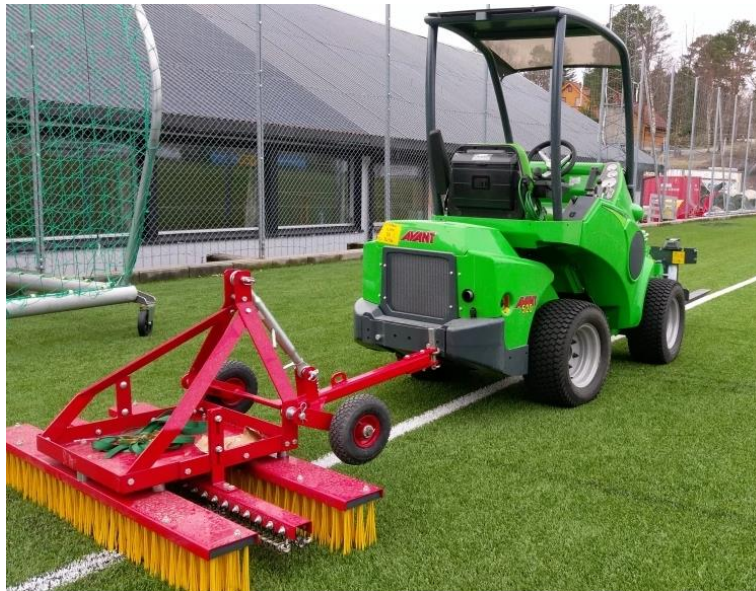
Figur 25: Eksempel på bruk av traktor og sloddebørste til fordeling av egenskapsfyll anbefalt av NFF [51].
