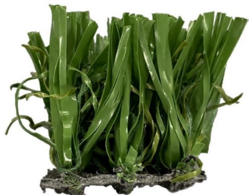
Fiber og backing fra 4G-bane uten ifyll
