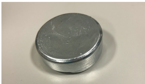
Figur 3.5: Ren sink - nikkel prøve før preparering.
