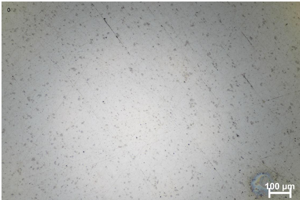
Figur 2: Bilde av et område på en ren Zn-Ni prøve tatt i OM med forstørrelse x10.
