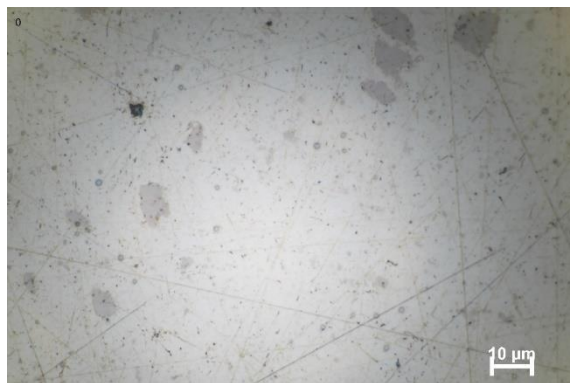
Figur 5: Bilde av et område på en ren Zn-Ni prøve tatt i OM med forstørrelse x100.
