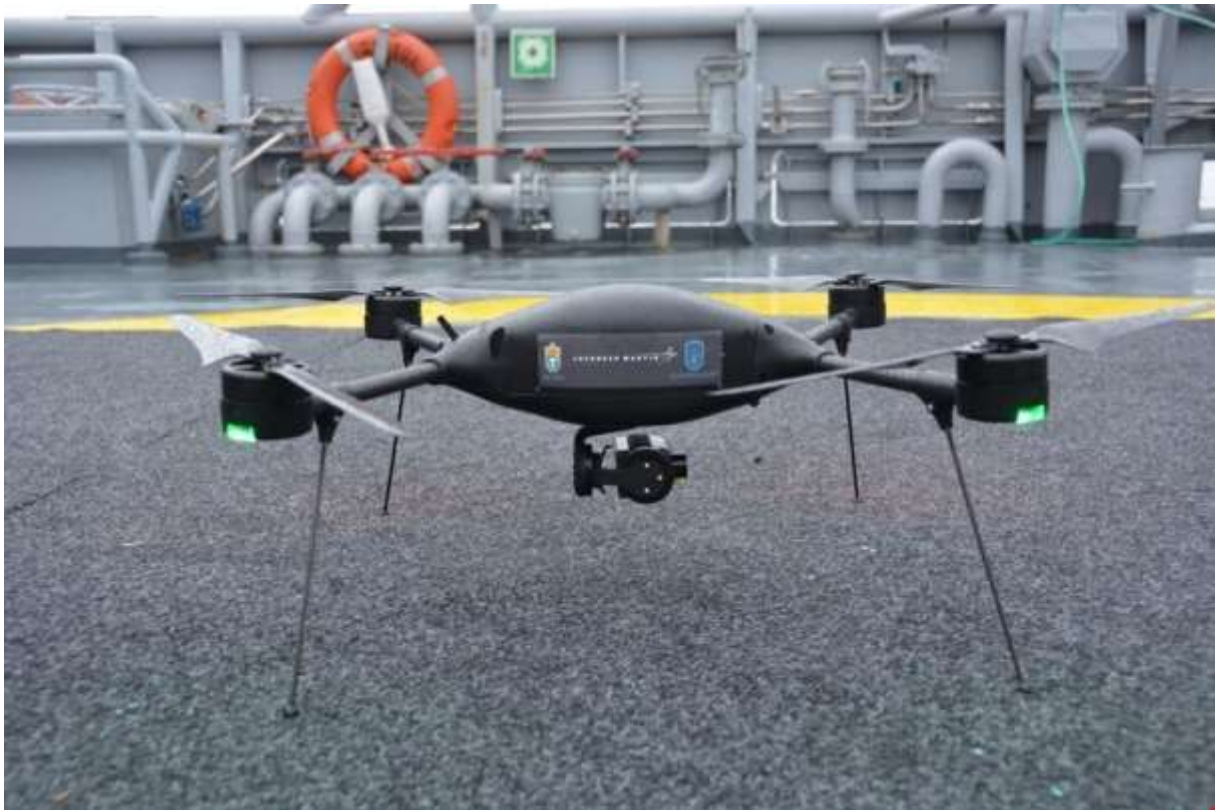
Figur 6: Drone med installert svovelsniffer (Stensvold, 2018)
